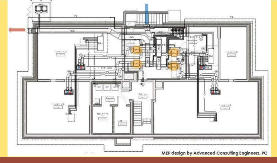
HVAC DESIGN ERV COMMON VENTILATION & DISTRIBUTION BY QUADRANT
